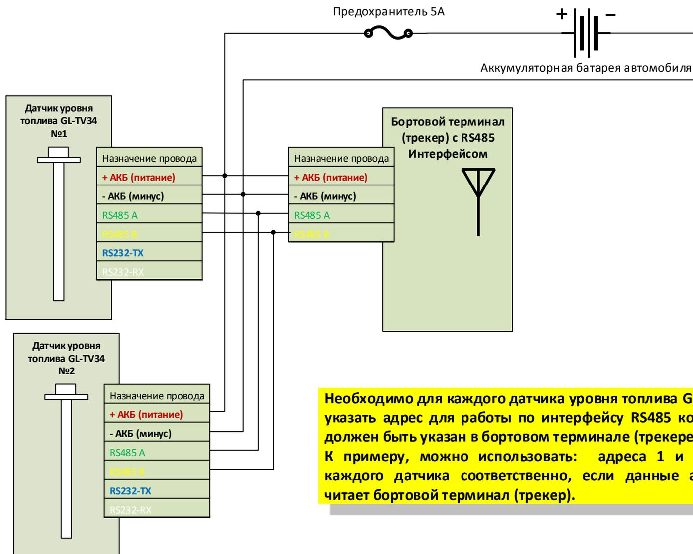
Необходимо для каждого датчика уровня топлива GL-TV34 указать адрес для работы по интерфейсу RS485 который должен быть указан в бортовом терминале (трекере). К примеру, можно использовать: адреса 1 и 2 для каждого датчика соответственно, если данные адреса читает бортовой терминал (трекер).
