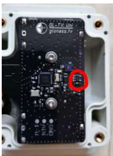
Рисунок 1 Место установки сенсора магнитного поля на плате датчика GL-TV Uni
