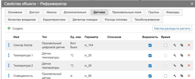
4.3. Создаем датчик Холла (электронный геркон) для контроля открытия и закрытия дверей для связки GL-TV Uni и терминала FMB920 в Wialon Hosting:
